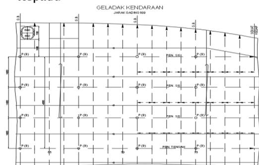
Gambar 2. Konstruksi Geladak Kendaraan Tampak Atas.
