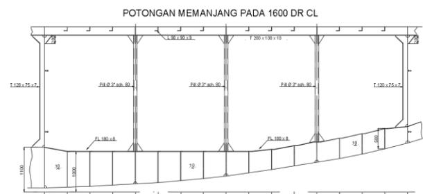
Gambar 3. Konstruksi Potongan Memanjang Hull Kapal
