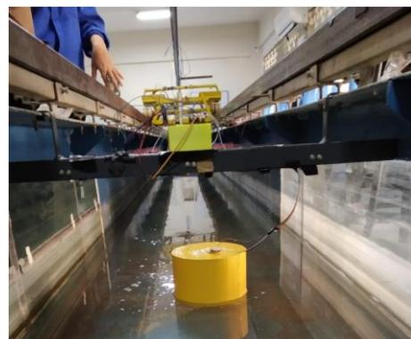
Gambar 8. Pemasangan alat ukur ke ponton.
