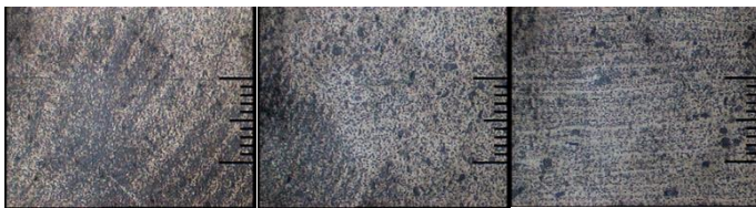
a) Daerah Las b) Daerah HAZ c) Daerah Base Metal
