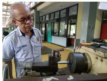
Gambar 7. Pembuatan pin tools dengan mesin bubut
