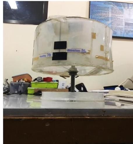
Gambar 8. Pemasangan Heaving Plate ke Ponton .
