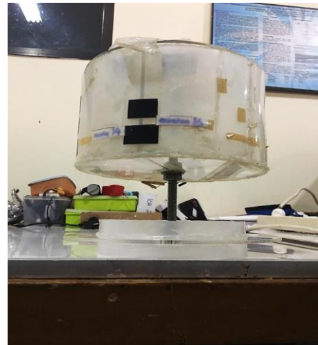
Gambar 8. Pemasangan Heaving Plate ke Ponton .
