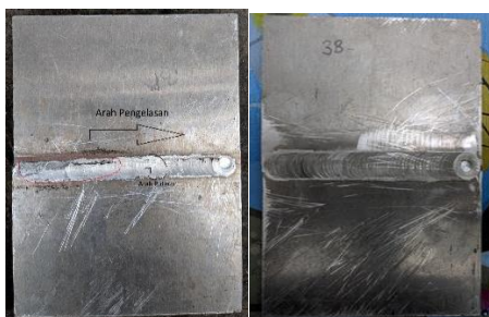
Gambar 8 Hasil Pengelasan Variasi Kedalaman pin 3 mm
