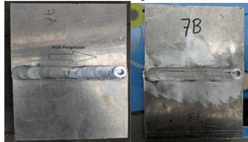
Gambar 10 Hasil Pengelasan Variasi Kedalaman pin 7 mm
