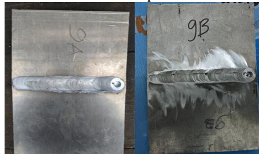
Gambar 11 Hasil Pengelasan variasi kedalaman pin 9 mm
