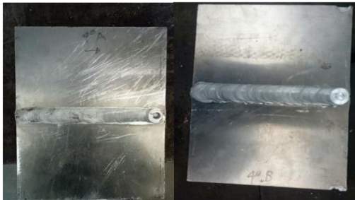
Gambar 7. Hasil Pengelasan Variasi tool tilt angle 4°
