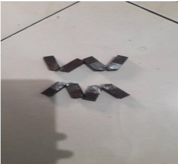
Gambar 11. Spesimen uji impak sesudah uji
