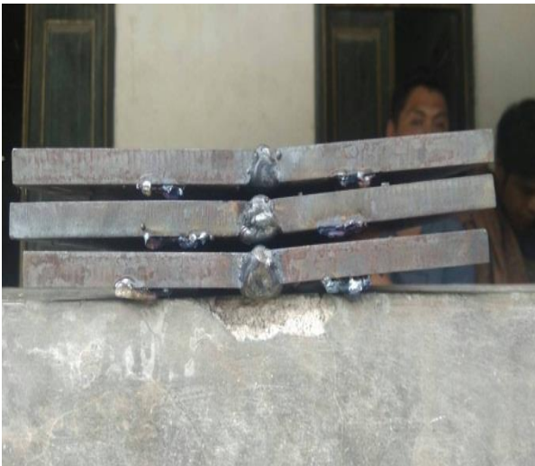
Gambar 3. Bentuk kampuh V setelah dilas
