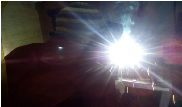
Gambar 7. Proses Pengelasan FCAW dengan Posisi 3G
