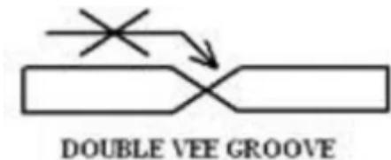
Gambar 3. Tipe Sambungan Las *Butt Joint Double V-Groove 60°*
