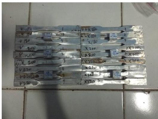
Gambar 9. Spesimen sebelum pengujian
