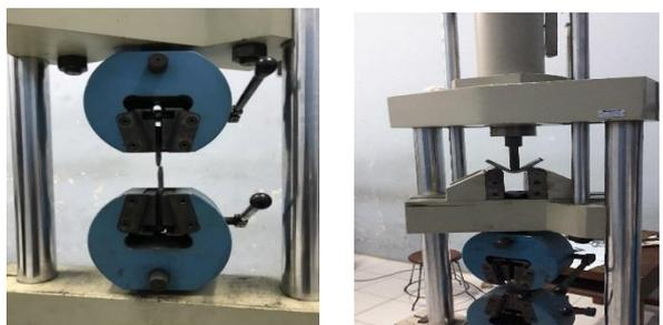
Gambar 11. Mesin Uji Tarik dan Tekuk
