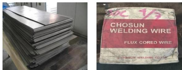
Gambar 13. Baja SS 400 dan Elektroda FCAW
