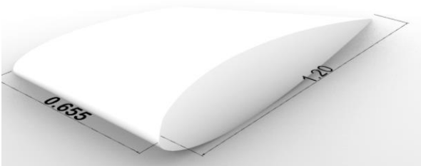
Gambar 4. Dimensi Fin Stabilizer Type 10 B
