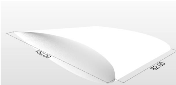
Gambar 3. Dimensi Fin Stabilizer Type 10 A
