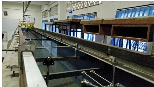
Gambar 1. Towing Tank Departemen Teknik Perkapalan Universitas Diponegoro
