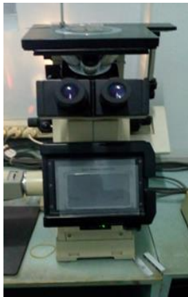
Gambar 4. Mikroskop Optik Pengamatan Struktur Mikro
