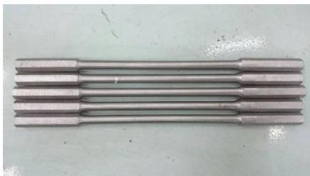
Gambar 2. spesimen pengujian puntir
