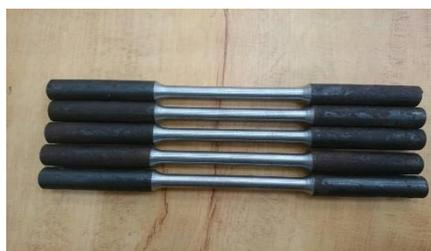
Gambar 3. spesimen pengujian tarik
