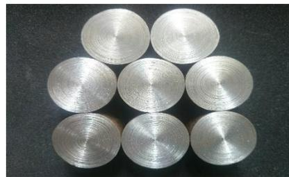
Gambar 4. spesimen pengujian kekerasan
