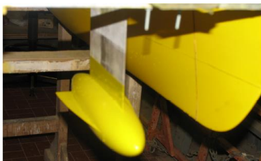
Gambar 2.3 Pengaplikasian Fin pada Centerbulb
