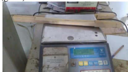
Gambar 4.1. Pengukuran Berat Spesimen
