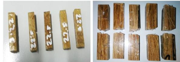
**Gambar 9.** Spesimen uji impak sebelum dan sesudah di lakukan pengujian
