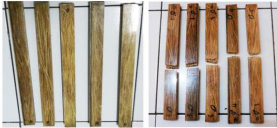
**Gambar 5.** Spesimen uji tekuk sebelum dan sesudah di lakukan pengujian
