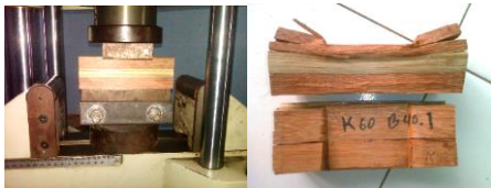
Gambar 9. Gambar proses pengujian tekan dan spesimen setelah diuji
