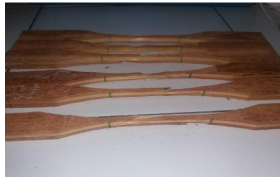
Gambar 4.6. Spesimen setelah di uji Tarik
