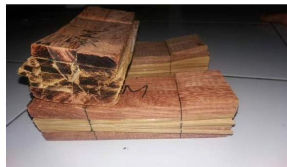
Gambar 4.9. spesimen setelah di uji tekan
