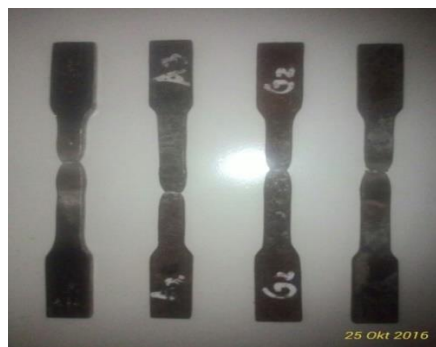
Gambar 7. Hasil Fisik Pengujian Tarik (dari kiri ke kanan spesimen raw material media air, air garam, dan oli)
