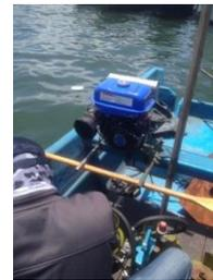
Gambar 3.24 Instalasi mesin pada kapal uji
