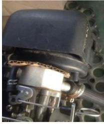
Gambar 3.18 Pemasangan mixer pada mesin
