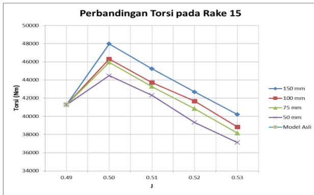
Gambar 12. Grafik Perbandingan *Torsi* pada Rake 15
