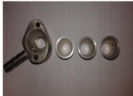
**Gambar 3** *mixer lubang outlet 4,6 dan 8*
