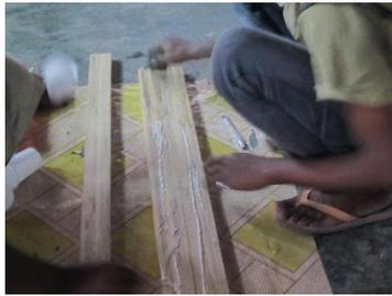
Gambar 4. Proses Pengeleman Lamina
