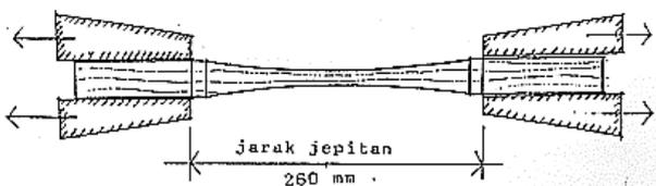
Gambar 9. Jarak Penjepit Pengujian Tarik
