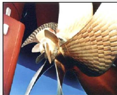
Gambar 1.3. Propeller Boss Cap Fin
