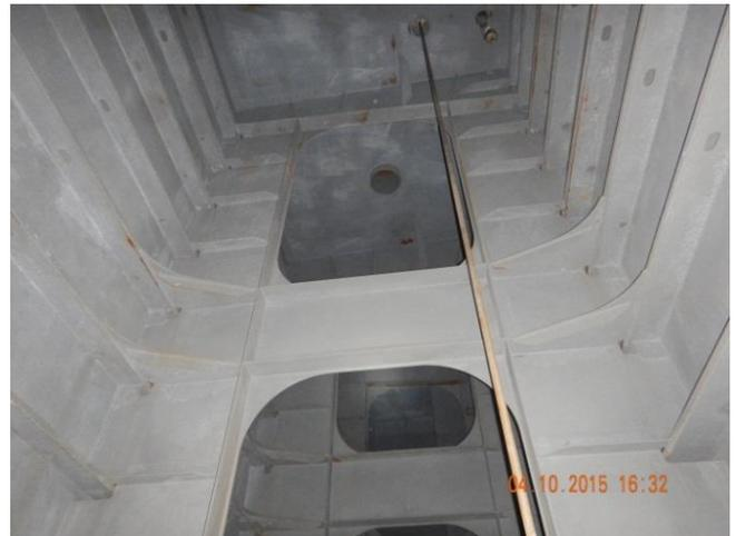
Gambar 3.5 *Cargo Wing Tank* yang akan dimodifikasi dengan penambahan *Inner Shell*
