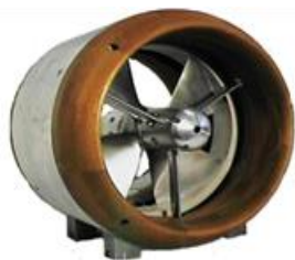
Gambar. 3 Kort nozzle Propeller
