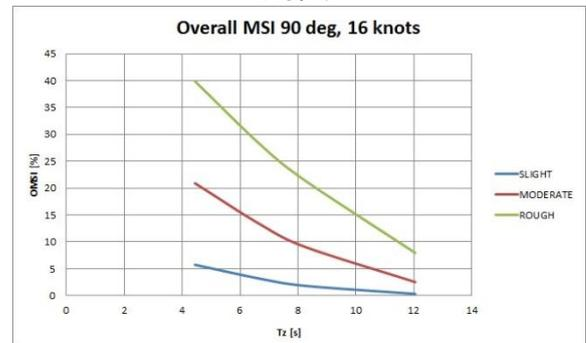
Gambar 25. Grafik OMSI pada heading angle  $90^\circ$  dan pada  $V_s = 8.23$  m/s, terlihat  $OMSI_{max}$  terjadi pada rough wave, saat  $T_z = 4.439$  s
