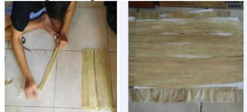
Gambar pembuatan serat daun nanas.
