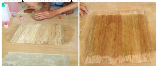
Gambar pembuatan spesimen komposit serat daun nanas.
