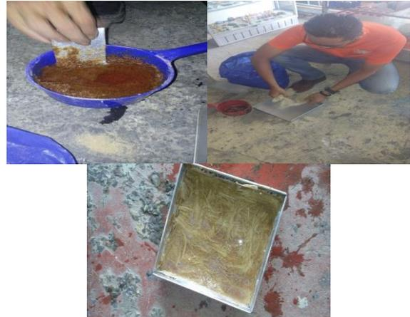
Gambar pembuatan spesimen komposit Sandwich
