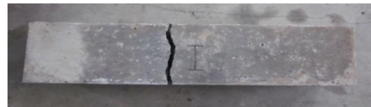
Gambar 7 Spesimen Uji Kuat Lentur setelah diuji
