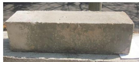
Gambar 4 Spesimen Uji Kuat Lentur
