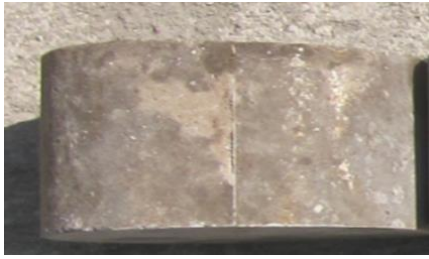
Gambar 5 Spesimen Uji Kuat Impak
