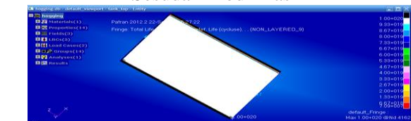
Gambar 17. Hasil Analisa MSC Nastran Hogging Sebelum Modifikasi
