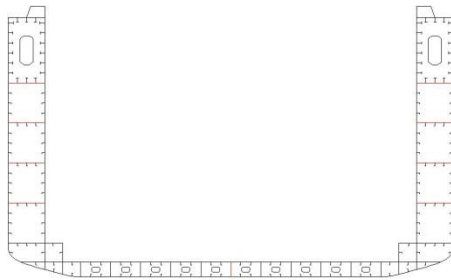
Gambar. 4 Permodelan Midship Section pada Autocad (BKI)
