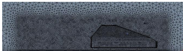
Gambar 7. Penggenerasian mesh Antawirya.
