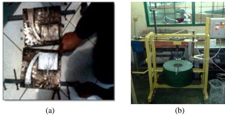
Gambar 2. (a) Hasil pengecoran (b) Mesin stir casting
