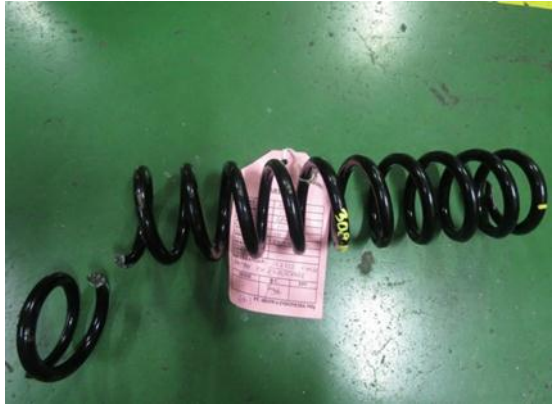
Gambar 7. Spesimen Coil Spring ATV-1A yang patah
