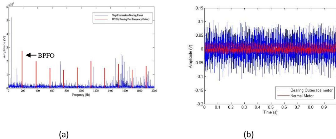
**Gambar 7.** Hasil pengukuran getaran (a) Frekuensi domain (b) Time domain motor dengan kerusakan Bearing pada 2300 Rpm
