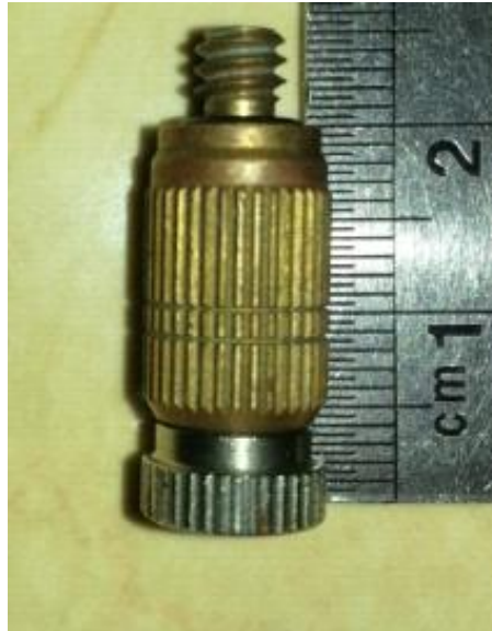
Gambar 4. Spraying nozzle yang digunakan pada dehumidifier tower .
