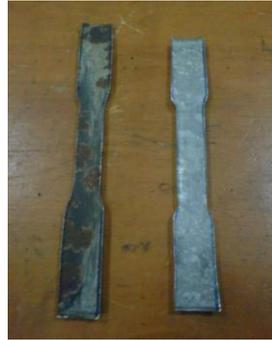
Gambar 4. Spesimen pengujian tarik
