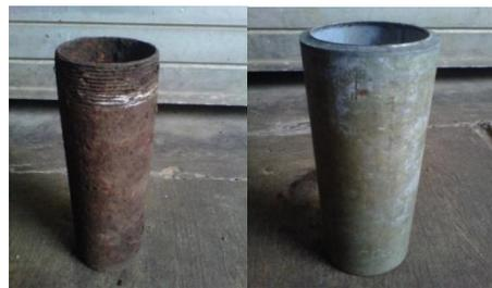
**Gambar 2.** Pipa korosi dan Pipa baru
