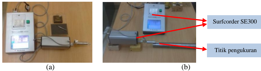
Gambar 8. (a) Surfscorder SE300 dan (b) proses pengujian kekasaran permukaan.
