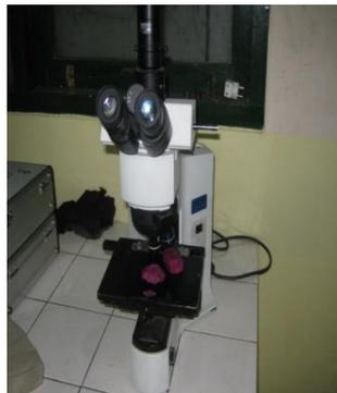
**Gambar 7.** Alat uji metalografi
