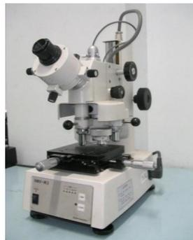
**Gambar 5.** Alat uji kekerasan vickers.
