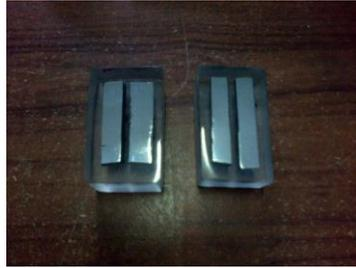
**Gambar 6.** Spesimen pengujian baja NP-42 Setelah di *mounting*.
