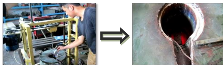
Gambar 2. Proses peleburan dengan tungku induksi.
