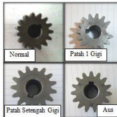
Gambar 3. Variasi kondisi kerusakan roda gigi
