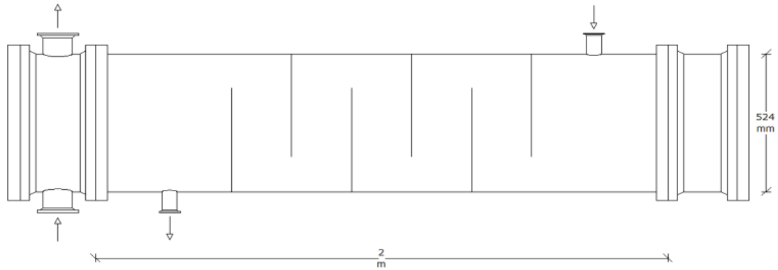
Gambar 4. Tube layout dan Shell (2D)
