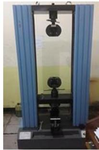
**Gambar 7.** Mesin Uji Tarik
