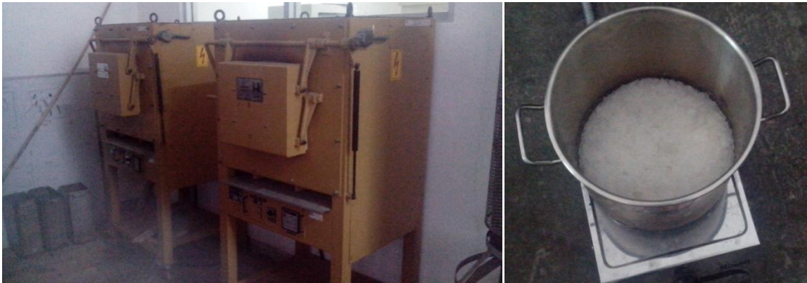
Gambar 3. Furnace Chamber dan Salth Bath dengan Garam KNO_3
