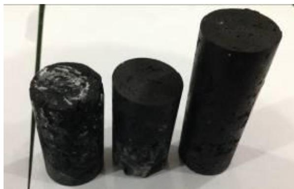
**Gambar 2.** Spesimen yang telah disintering
