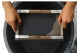
Gambar 4. Proses pengayakan dengan 100 mesh
