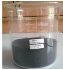
Gambar 6. Sampel raw material pasir besi untuk pengujian AAS
