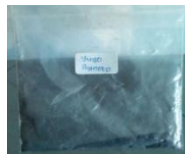
Gambar 11. Sampel sponge iron yang telah hancurkan menjadi butiran kecil untuk pengujian AAS
