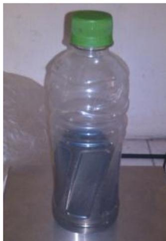
**Gambar 11.** Sampel *raw material* pasir besi untuk pengujian AAS
