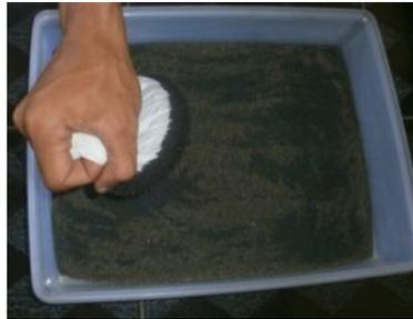
**Gambar 3.** Proses ekstraksi pasir besi dengan magnet
