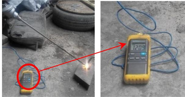
**Gambar 9.** Pengukuran suhu dengan thermokopel mencapai suhu 1200°C
