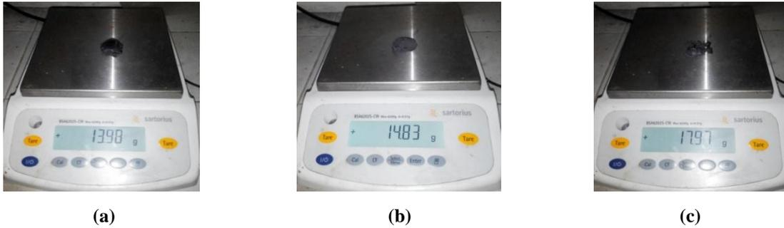
**Gambar 2.** (a) Spesimen Uji 1 13,98 gr, (b) Spesimen Uji 2 14,83 gr, (c) Spesimen Uji 3 17,97 gr
