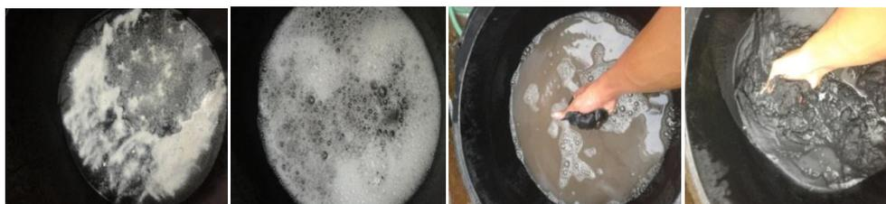
**Gambar 5.** Pencucian pasir besi dengan detergen
