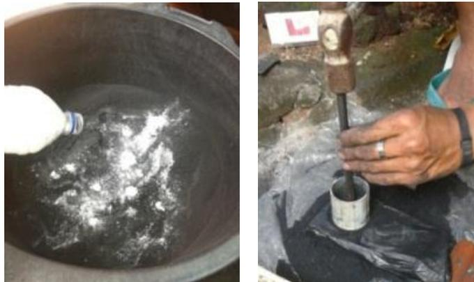
**Gambar 7.** Proses pencampuran dan kompaksi
