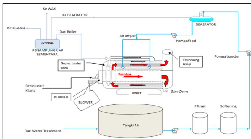
Gambar 1. Diagram Sirkulasi Air dan Uap pada boiler[12].
